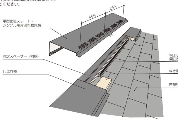
換気棟(本体)の取付け穴は455mmピッチになっています。
