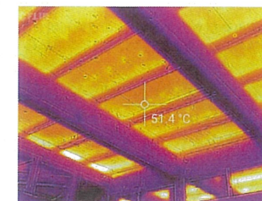
夏的小屋裏の天井面。表面温度が50℃を超えている
