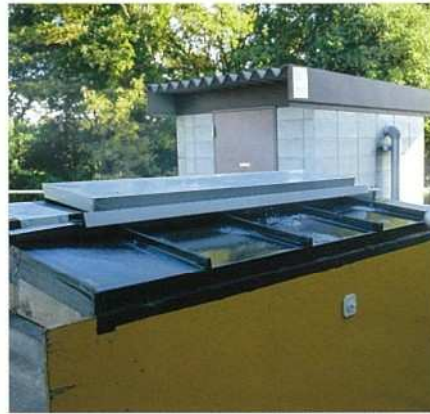
散水試験機。実際に水を横から当て、漏れが生じないかを確認できる。写真は風速35m/sの暴風雨を想定した防水性の実験。水を10分間当てて一滴も入らなければ、合格となる
