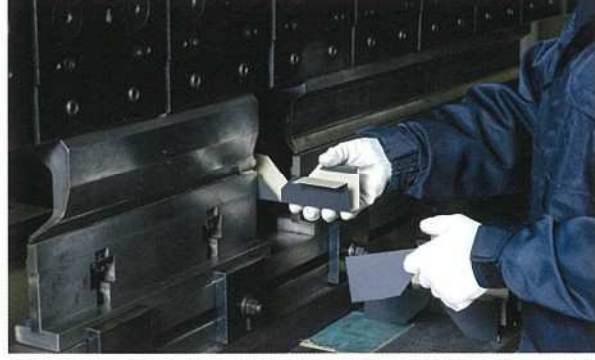
曲げ加工を施す部品の素材は全て、機械に対して直角に、正確に当てることが要求され、熟練した職人技が求められる
