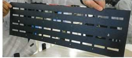
タレットパンチプレスによる穴開け工程。全て自動で、人が近づくとセンサーが作動し、停止する
