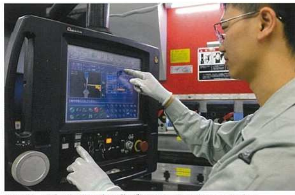
モニターで部品が正確に曲げられているかをチェックする
