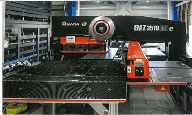
タレットパンチプレスによる穴開け工程。全て自動で、人が近づくとセンサーが作動し、停止する
